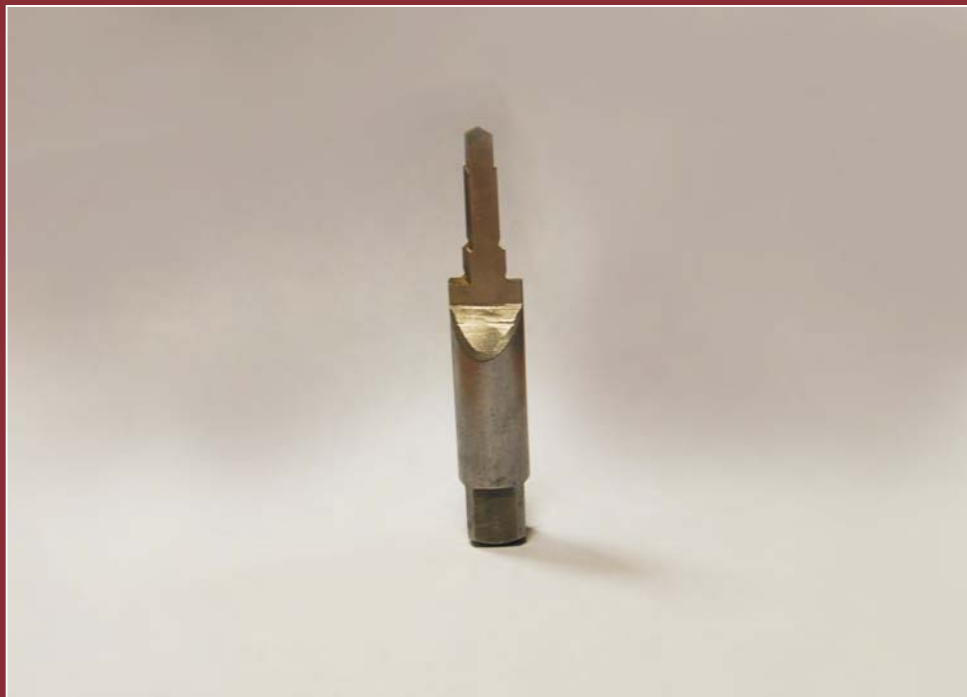
Utensile Punta a lancia ricavato da gambo di maschio
