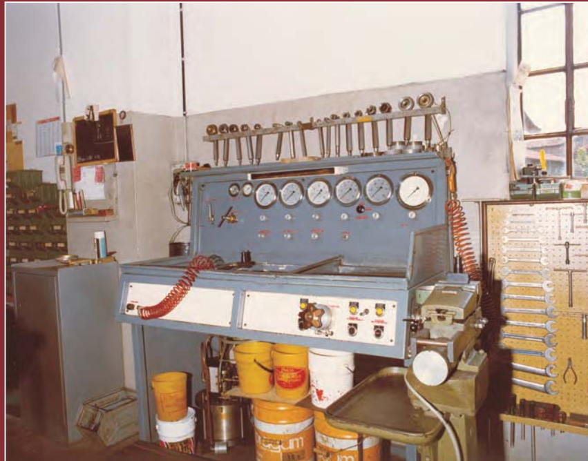
Banco prova per tenuta valvole oleodinamiche
